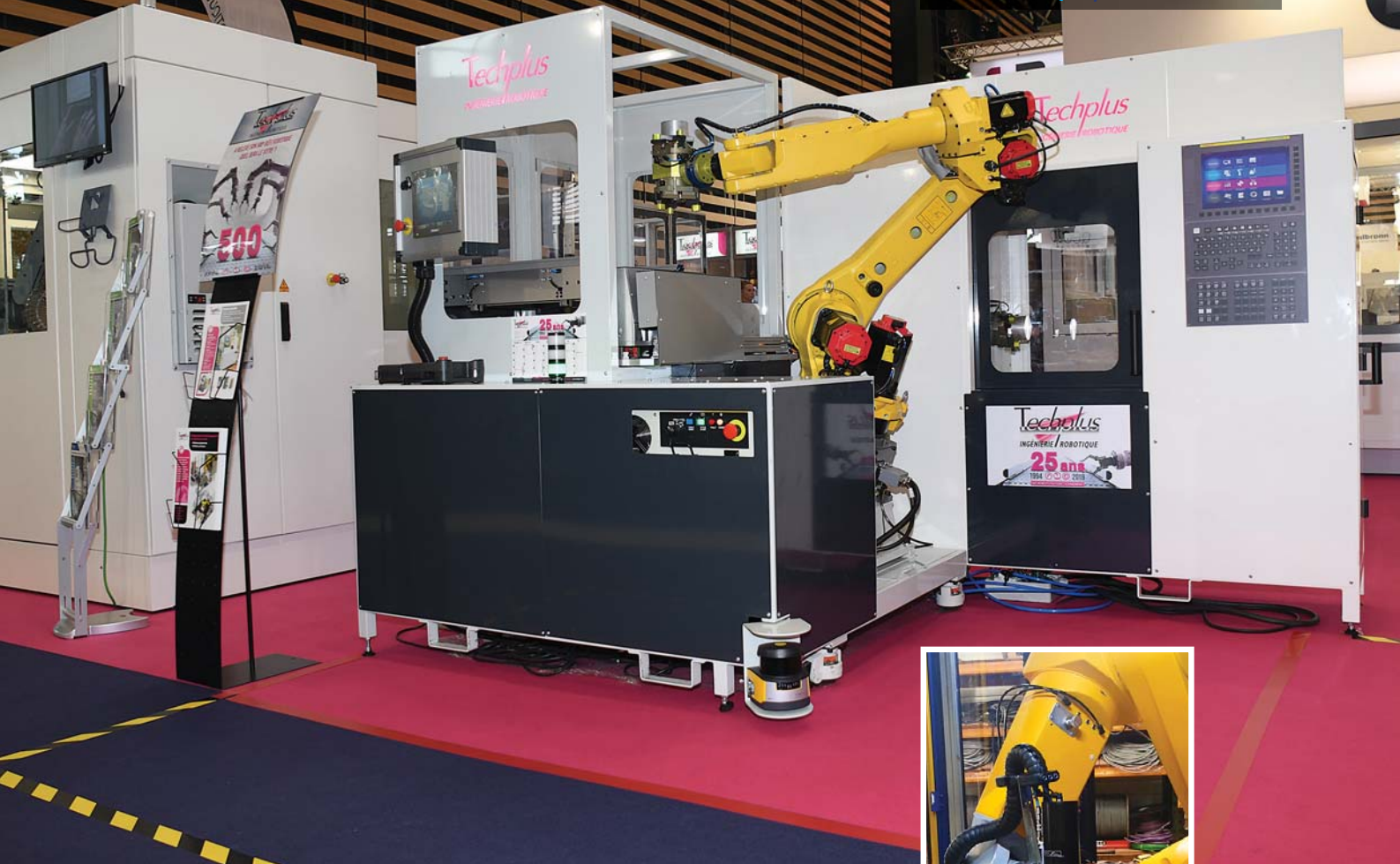
Une cellule robotisée de l'intégrateur Techplus, dont le nombre d'installations devrait dépasser les 600 en 2020. En médaillon : Illustration d'une cellule d'ébavurage/usinage.
