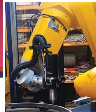
Une cellule robotisée de l'intégrateur Techplus, dont le nombre d'installations devrait dépasser les 600 en 2020. En médaillon : Illustration d'une cellule d'ébavurage/usinage.
