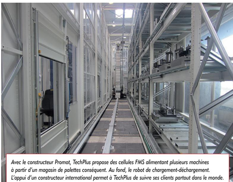
With the constructor Promot, TechPlus propose des cellules FMS alimentant plusieurs machines à partir d'un magasin de palettes conséquent. Au fond, le robot de chargement-déchargement. L'appui d'un constructeur international permet à TechPlus de suivre ses clients partout dans le monde.
